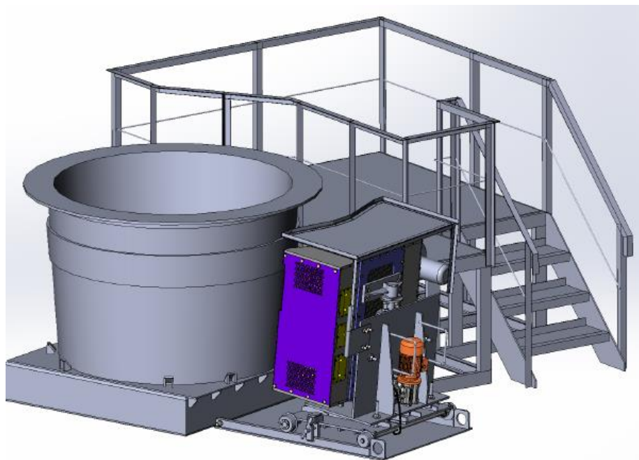
Рисунок 2.7 – Установка электромагнитного перемешивания в ковше
