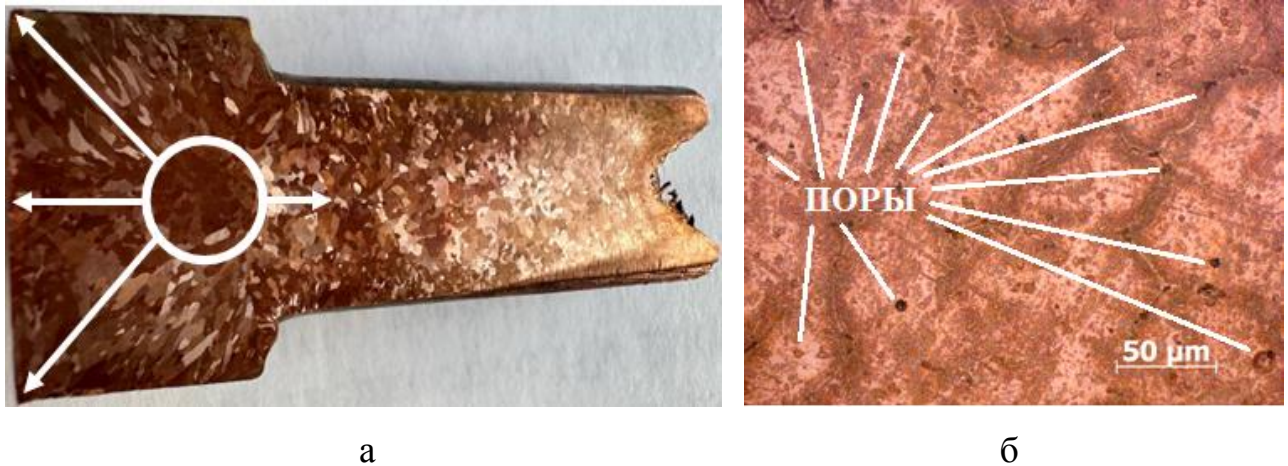
Рисунок 3.21 – Макроструктура с градиентами температур (а) и микроструктура с распределённой микропористостью (б) литого электрода
