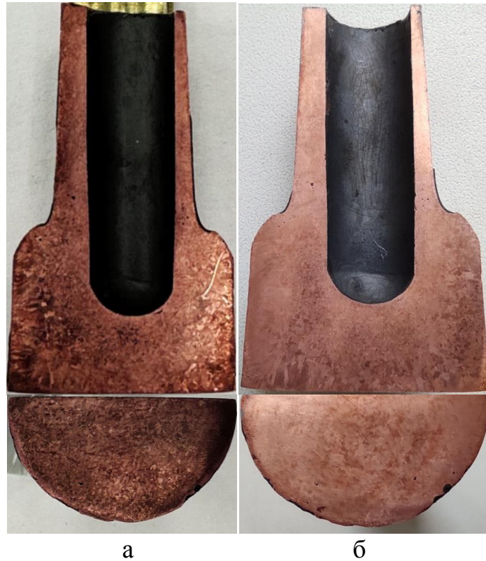
Рисунок 4.12 – Макроструктура литых - штампованных электродов: (а) литье - штамповка - закалка; (б) литье - штамповка - закалка - старение
