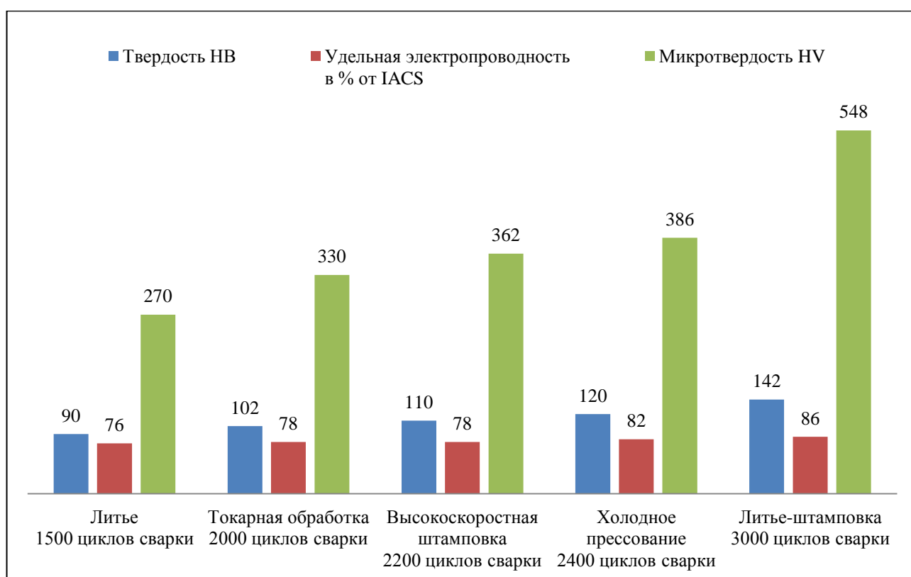
Рисунок 5.1 – Значения твёрдости, удельной электропроводности и микротвёрдости от количества циклов сварки
