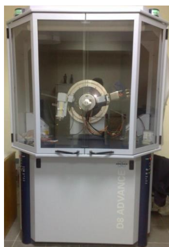
Рисунок 2.9 – Дифрактометр BRUKER D8 ADVANCE (а) и рентгенооптическая схема с ходом лучей в плоскости фокусировки дифрактометра по Брэггу–Брентано
