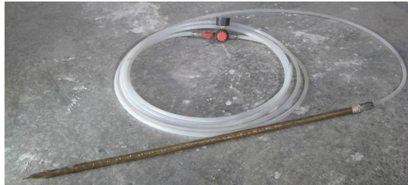
Рисунок 3.6 - Электронагреватель для прогрева изложницы ( а ) и устройство для подачи сжатого воздуха ( б )
