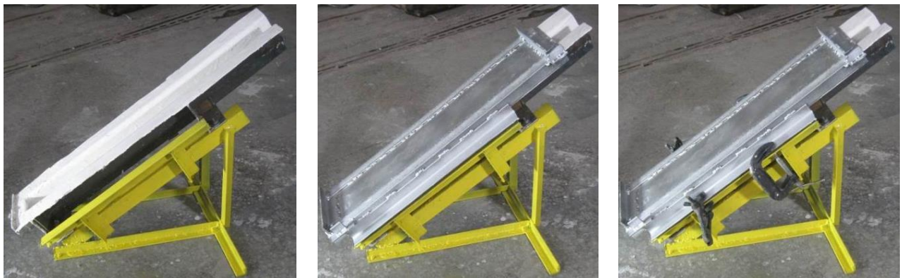
Рисунок 3.3 - Основание изложницы на металлокаркасе ( а ) с установленной ( б ) и закрепленной ( в ) крышкой
