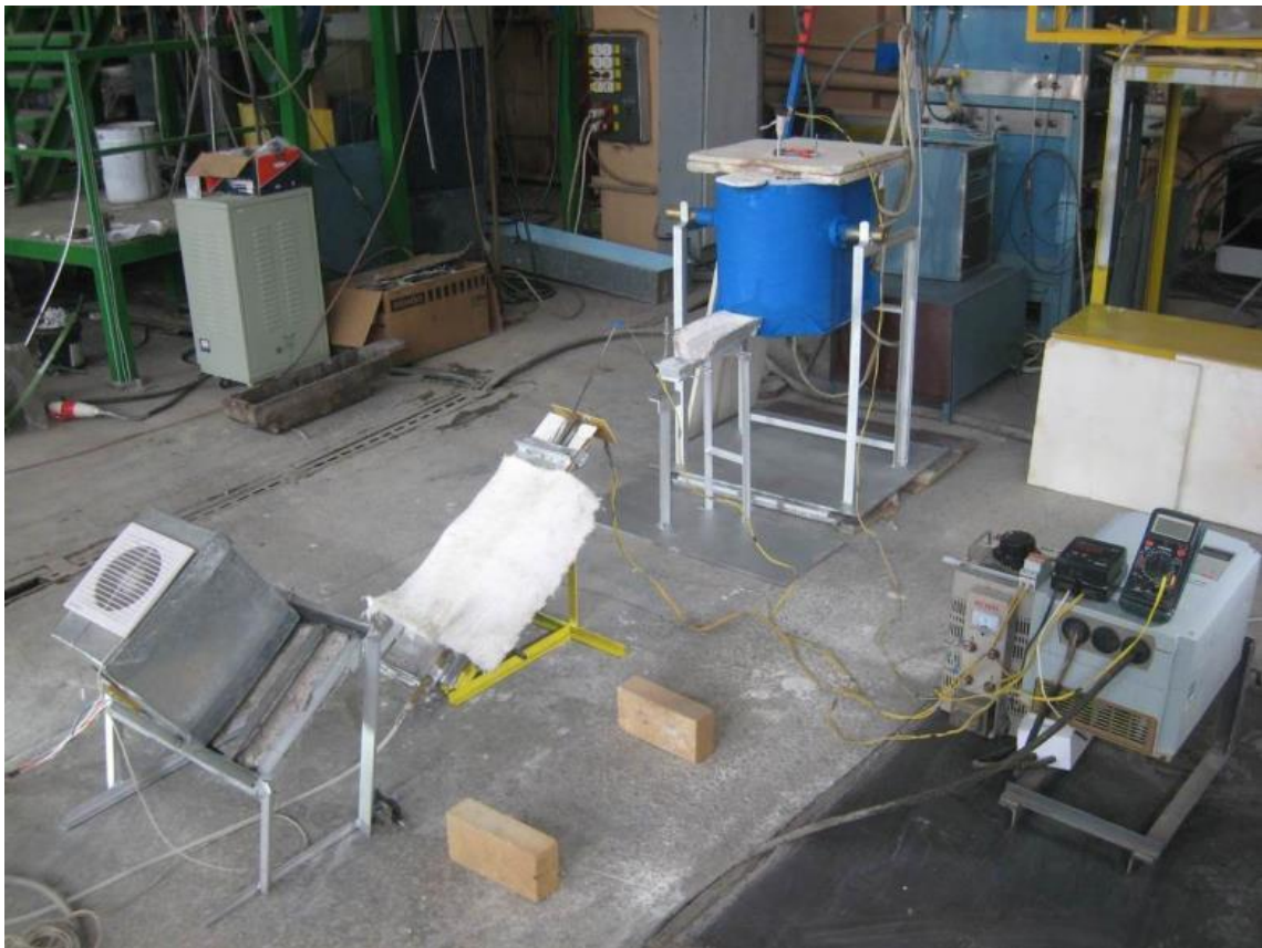
Рисунок 3.9 - Лабораторная установка при прогреве изложницы (элементы установки разнесены, нагреватель установлен в изложницу)
