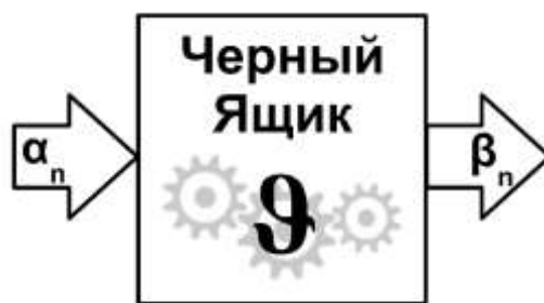
Рис. 2. Модель «черный ящик». \alpha_n – входной сигналы, \beta_n – выходные сигналы, \mathcal{Z} – характеристика ЧЯ (его устройство, алгоритм поведения)
