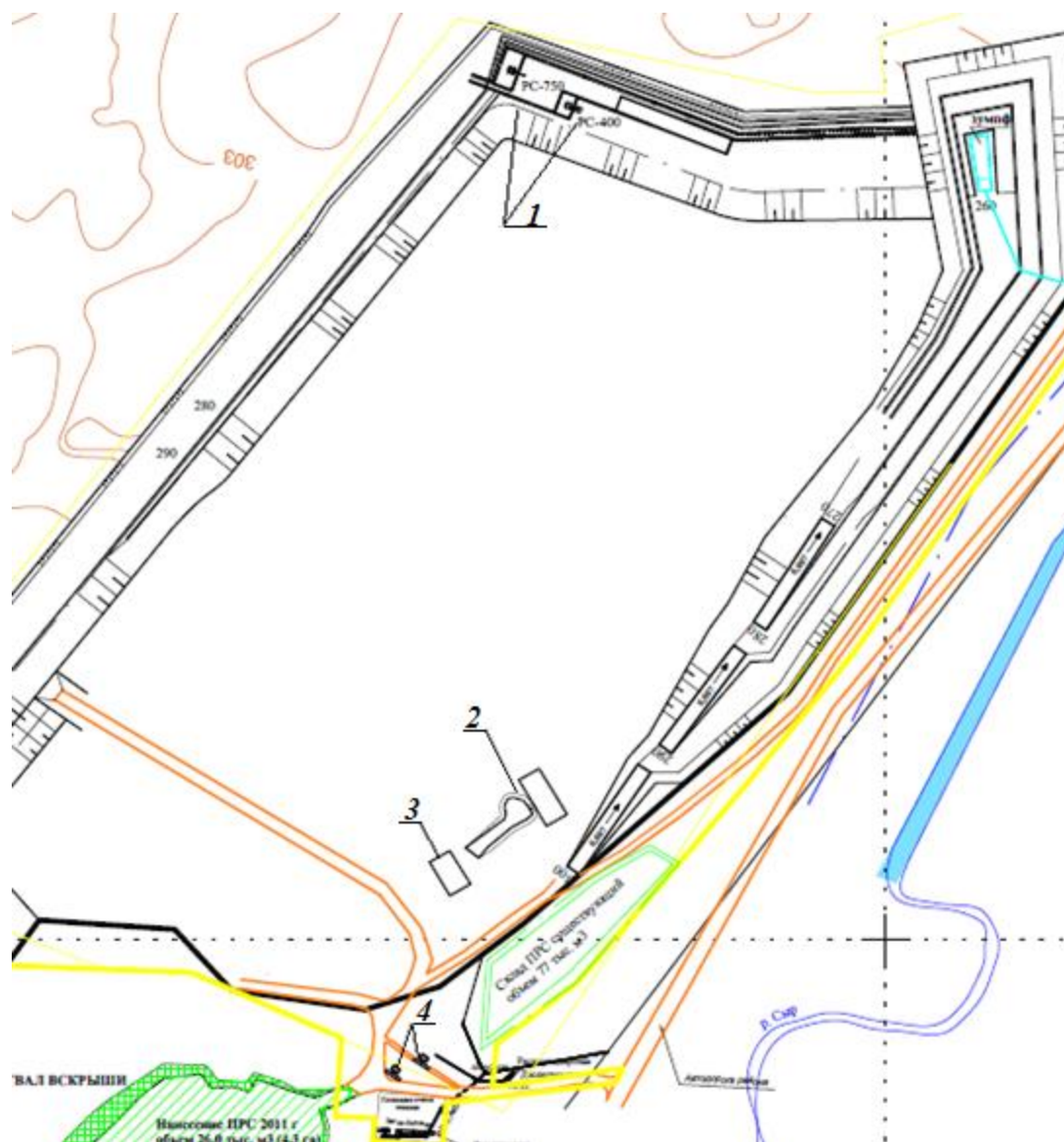
Рисунок 5.2 – Схема разработки участка «Новый» Большесырского месторождения компанией ООО «СибУголь»: 1 – добычные забои; 2 – передвижная дробильно-сортировочная установка; 3 – фасовочный цех; 4 – весы
