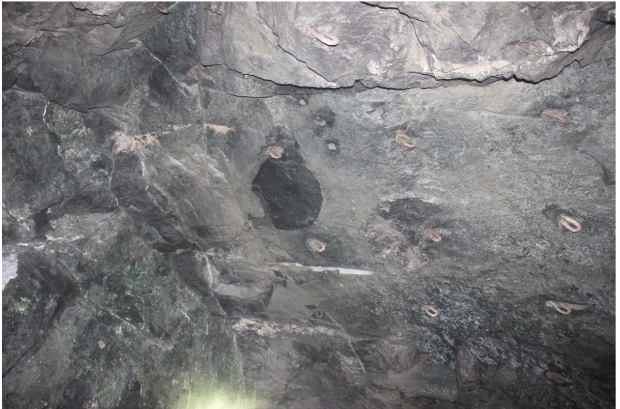
Рисунок 3.27 – Левый бок забоя после первого взрыва
