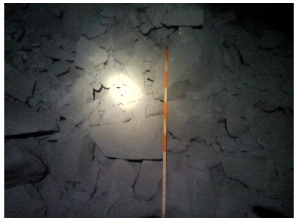
Рисунок 3.25 – Оценка степени дробления горной массы после взрыва
