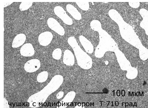
Рисунок 4.4 – Микроструктура образцов силумина эвтектического состава, отлитых с УДП и без него при разных температурах: a – без УДП при температуре литья 750 °С; б–г – с УДП при температуре литья 720 ( б ), 750 ( в ) и 780 ( г ) °С
