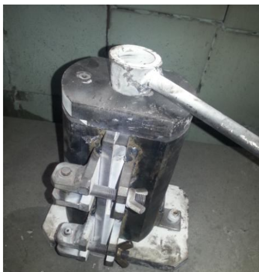
Рисунок 2.3 – Кокиль для изготовления технологических проб
