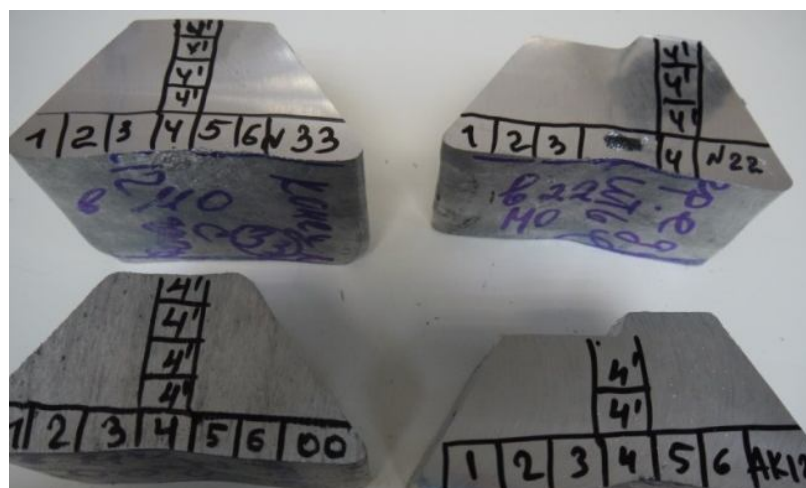
Рисунок 4.2 – Схема разметки контрольных образцов на макро- и микроструктуру (а) и механических свойств (б)
