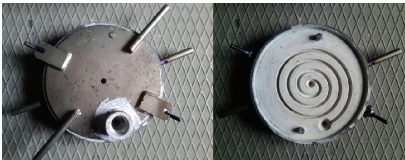
Рисунок 2.6 – Металлическая форма для получения проб жидкотекучести металлов
