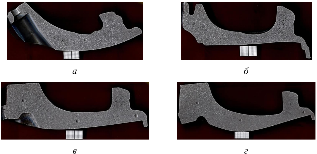
Рисунок 4.19 – Макроструктура колес, отлитых из сплава АК12, модифицированного лигатурой AlTi5B1 по серийной технологии (а, б) и гранулированным флюсом (в, г) автомобильных колес 17”Либерти (а, в) и 16”Борелли (б, г). Размер зерна (д), мм: а – 1,1; б – 1,14; в – 0,34; г – 0,64
