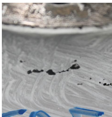
Рисунок 3.11 – Зона зарождения трещины
