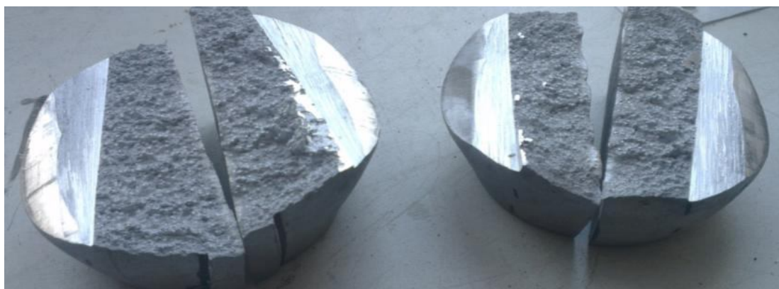
Рисунок 2.5 – Изломы технологических проб
