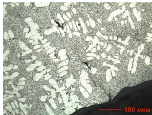
Рисунок 3.12 – Микроструктура отливки вблизи зоны разрушения
