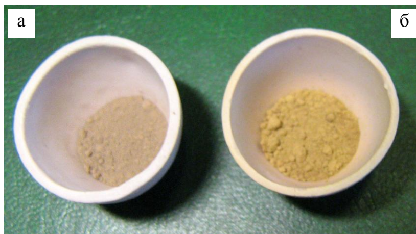
Рисунок 3.8 – Внешний вид металл-оксидных порошков после отжига: а – без использования ПАВ; б – с использованием ПАВ
