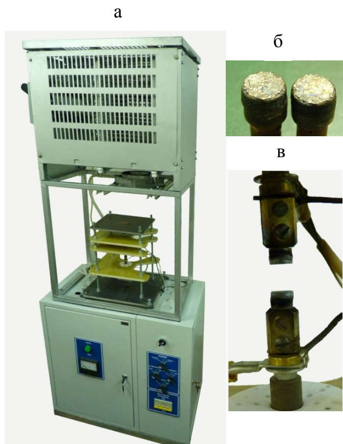
Рисунок 2.3 – Фотографии элементов стенда для измерения эрозионных свойств электроконтактных материалов; а – основная стойка установки, б – контактная пара, в – устройство крепления и перемещения контактных элементов
