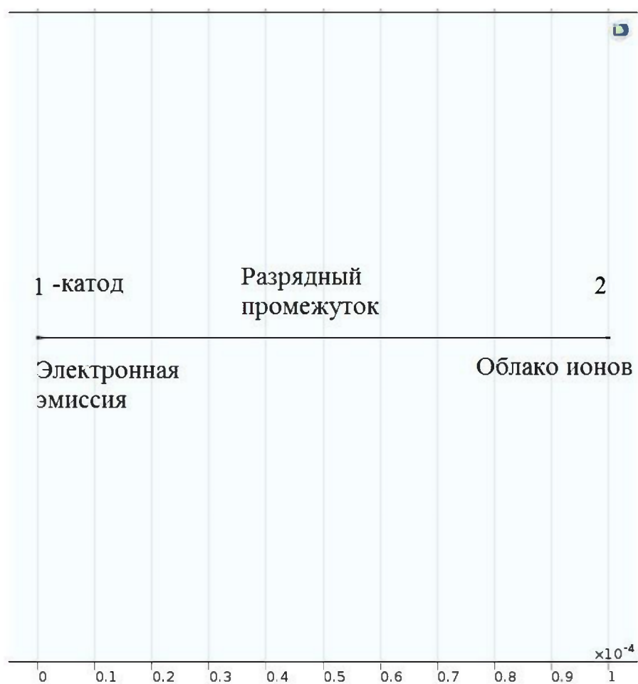
Рисунок 4.1 Схема расчетной области для одномерной модели.
