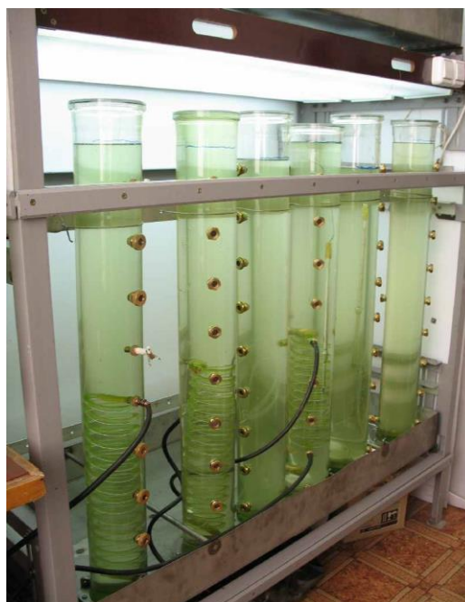
Рисунок 5 – Установка по изучению вертикального распределения зоопланктона, шесть стеклянных мезокосов
