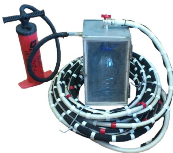
Рисунок 4 – Шланговый пробоотборник с ручным насосом и вакуумной камерой под емкости объемом 5 литров
