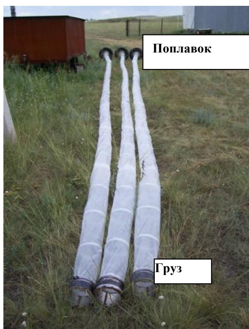
Рисунок 6 – Внешний вид «выделенных объемов» для исследования индивидуальных миграций зоопланктона. Длина труб 15м, диаметр - 15см
