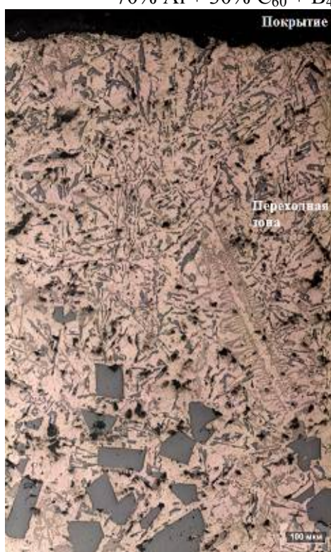
Рисунок 8 – Структура переходной зоны образца, напыленного составом 70% Al + 30% C + V_4C_5 , светлое поле
