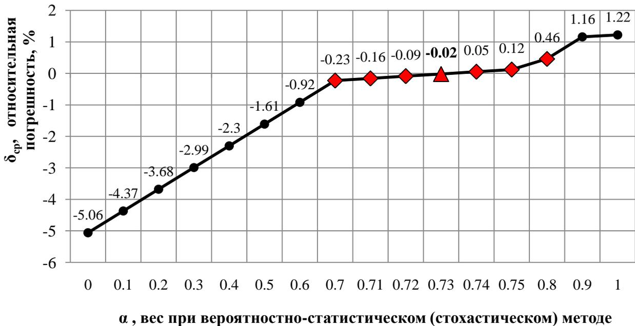
Рисунок 1. Изменение относительной погрешности  $\delta_{ср}$  при различном сочетании веса детерминированного и стохастического методов расчёта потерь ЭЭ.
