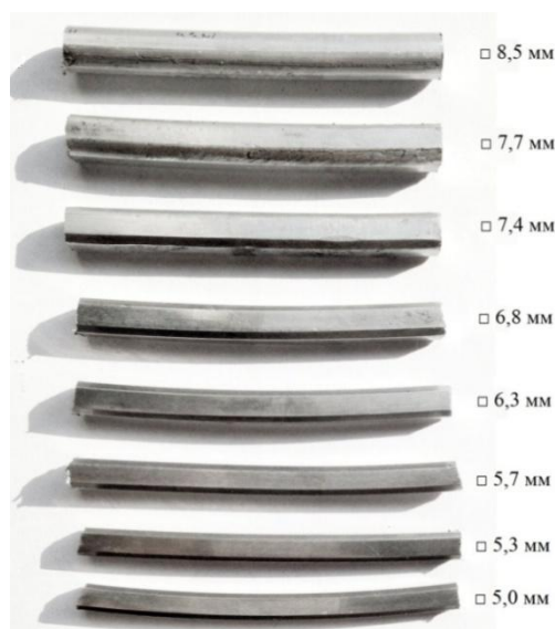
Рисунок 7 – Внешний вид прутков после сортовой прокатки
