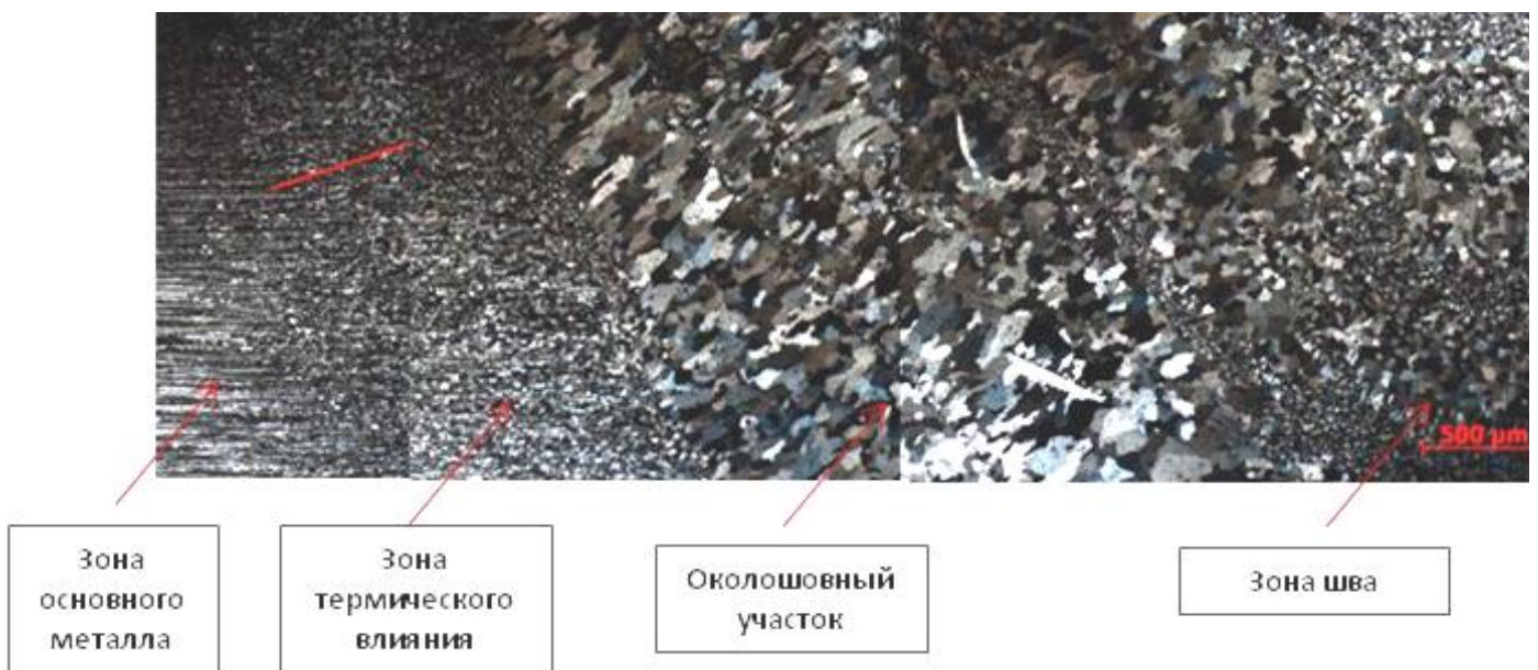
Рисунок 6 – Характерные зоны сварных соединений на микроструктуре образцов, \times 50
