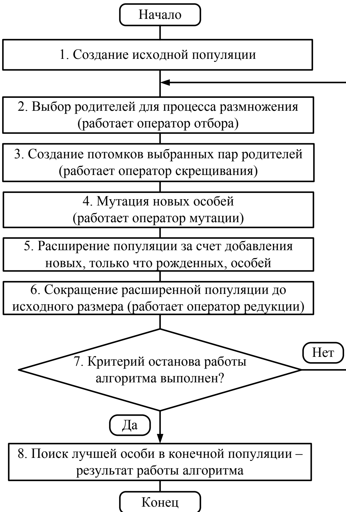
Рисунок 3 – Упрощенная блок схема генетического алгоритма
