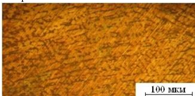
Рисунок 4 – Микроструктура КМ на основе меди марки М1, упрочненного дисперсными частицами TiC (x200)
