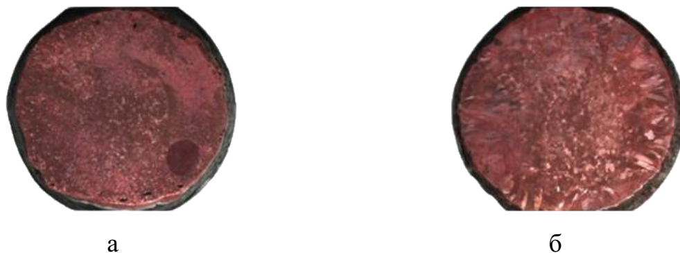
Рисунок 9 – Макроструктура а) технической меди и б) композиционного материала системы Cu-CrV 2
