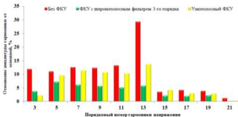
Рисунок 11 – Спектры напряжения на токоприемнике ЭПС после установки ФКУ в тяговой сети.
