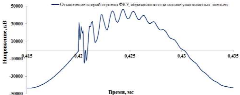
Рисунок 14 – Переходный процесс при отключении второй ступени ФКУ на основе узкополосных звеньев
