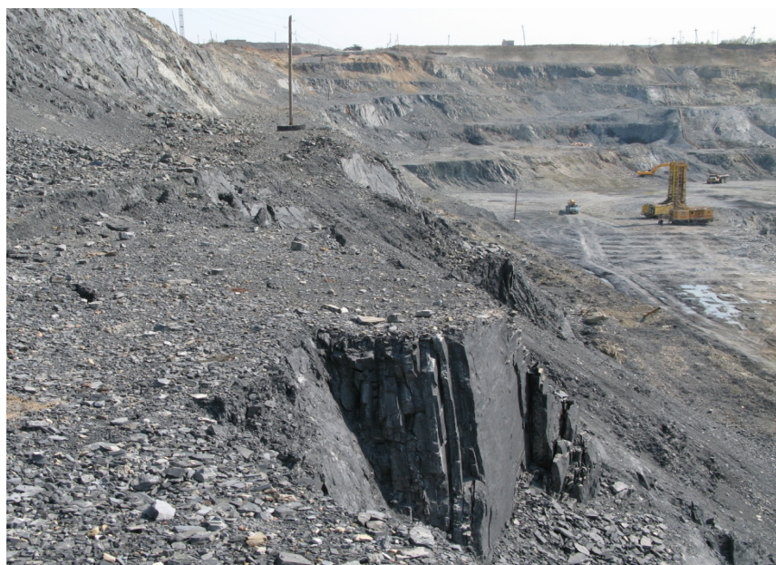
Рисунок 8 - Заколы после обрушения пород на горизонте +65м
