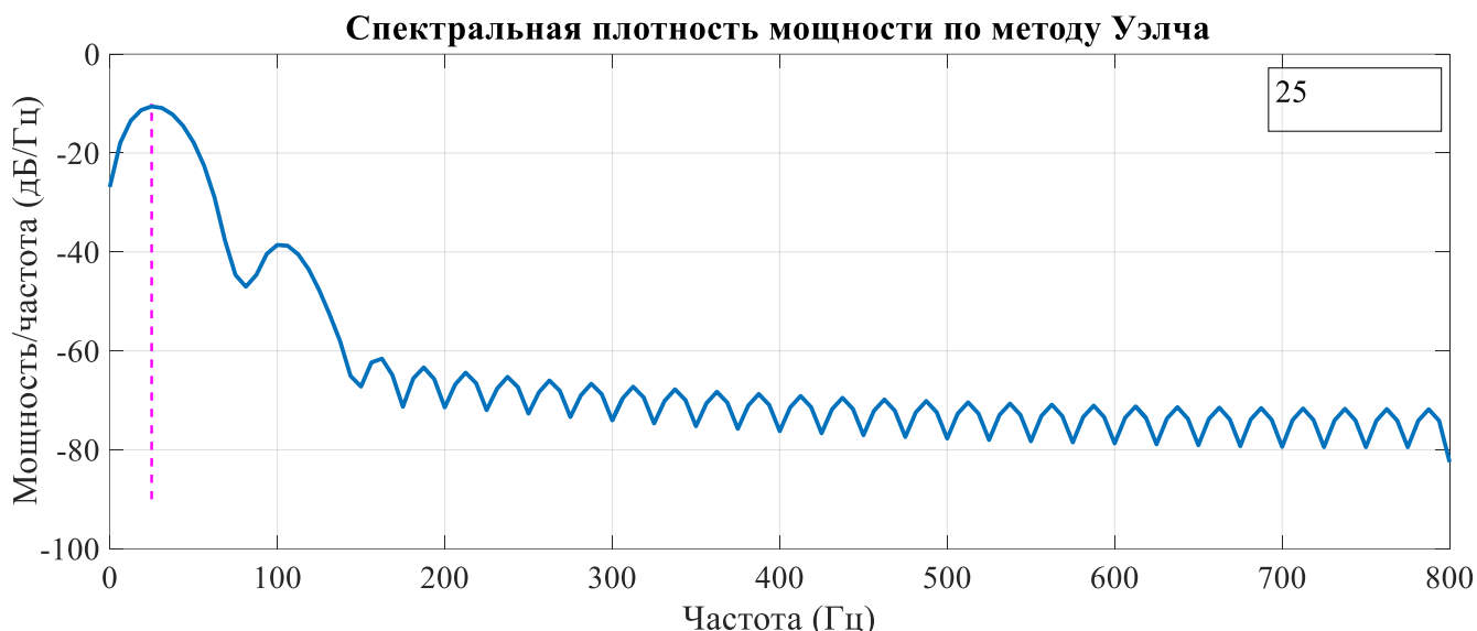
Рисунок 18 – Определение частоты напряжения свободных колебаний по методу Уэлча
