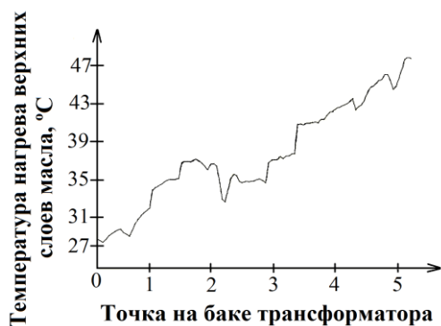
Рисунок 6 - Изменение температуры трансформатора при повышенной массе состава
