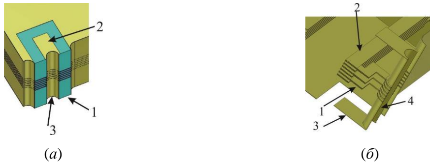
Рисунок 13 – Копланарный переход (1, 2) для подключения точки (3) к линии передачи при поверхностном монтаже фильтра на плате (а); Разрез в области копланарной линии, образованной металлизированным отверстием (4), соединяющим несмежные проводники (б)
