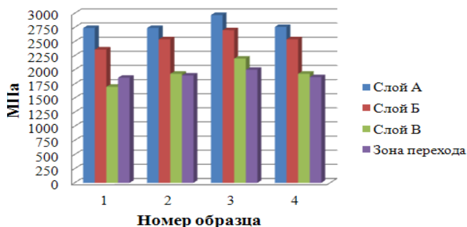
Рисунок 7 – Влияние различных модификаторов на микротвердость: 1 – без порошка; 2 – с добавлением порошка W; 3 – с добавлением порошка AlO(OH) ; 4 – с добавлением порошка Mo
