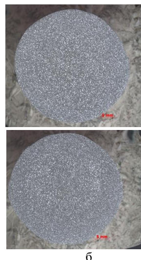
Рисунок 6 – Влияние расхода лигатуры Al-Ti5-B1 на размер зерна: а. – изменение размера зерна от расхода лигатурного прутка для сплава 5083; б. - Макроструктура исследуемых проб x50
