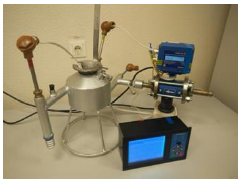
Рисунок 5 – Общий вид устройства для исследования модифицирующей способности лигатур
