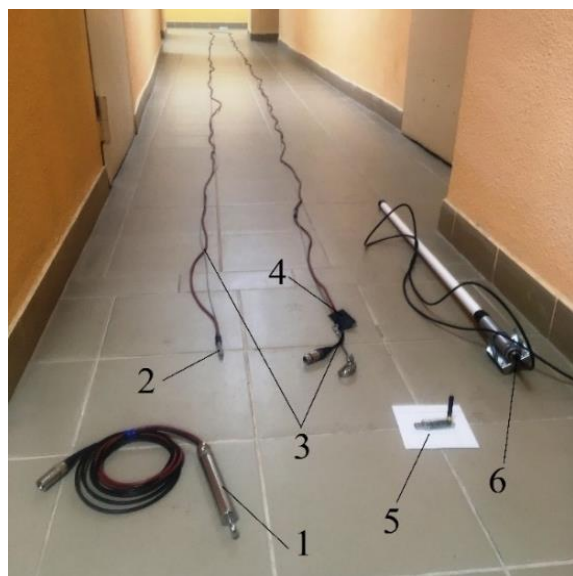
Рисунок 1 – Общий вид комплекта ЛЦД-1/100-PM: 1 – ЛЦД-1/100-PM; 2 – датчиков температуры МЦДТ 0922; 3 – термокоса; 4 – схема установки термодатчиков; 5 – переходник USB/PM с антенной; 6 – антенна
