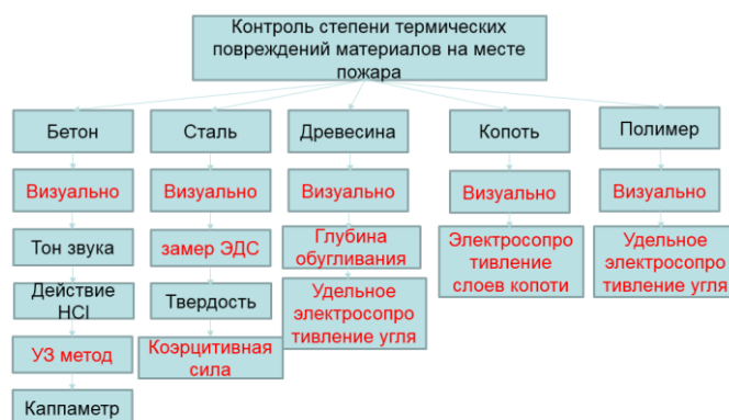
Рисунок 1 – Методы контроля степени термических повреждений материалов на месте пожара
