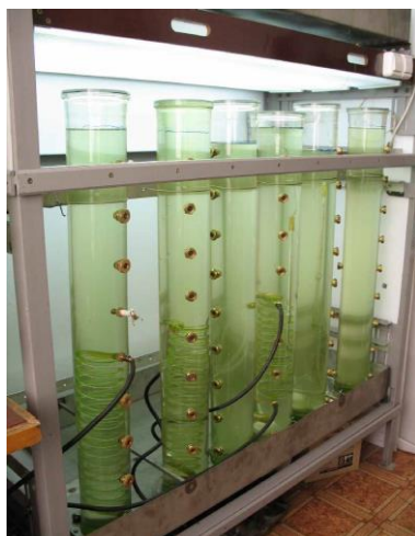
Рисунок 1 – Установка по изучению вертикального распределения зоопланктона, шесть стеклянных мезокосмов
