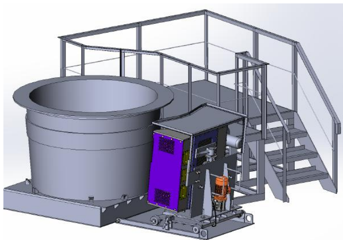
Рисунок 9 – Установка электромагнитного перемешивания в ковше
