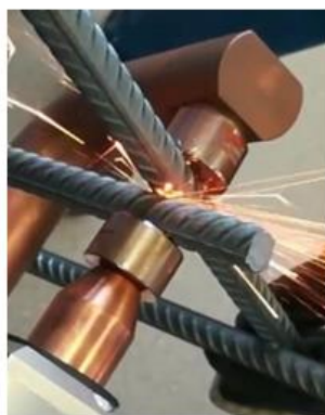
Рисунок 11 – Сварка арматуры вкрест (а) и график взаимосвязи количества сварных соединений от свойств электродов (б): твёрдости HB, микротвёрдости HV и удельной электропроводности % IACS
