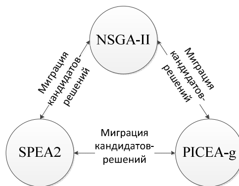
Рисунок 1 – Общая схема кооперации многокритериальных эволюционных алгоритмов на основе островной модели
