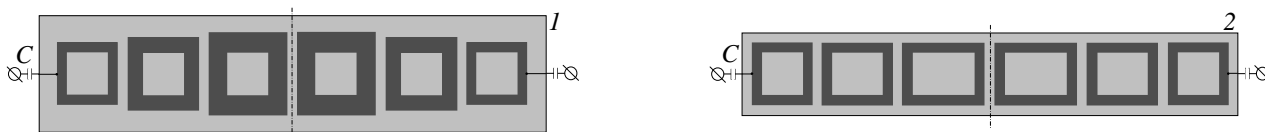
Рис. 5. Схематическое изображение топологий одномерных МФК для реализации полосно-пропускающих фильтров
