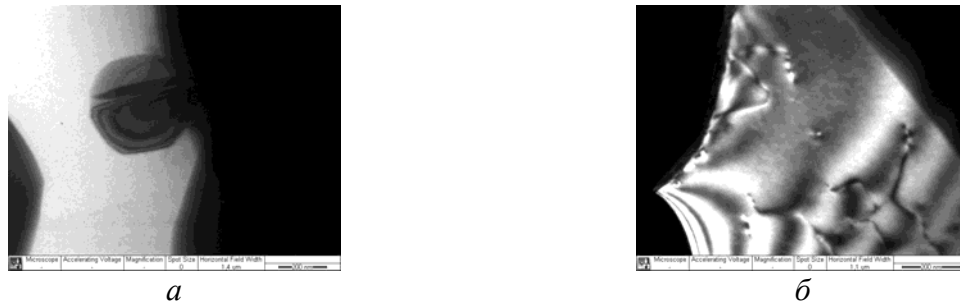
Рисунок 20 – Частица карбида кремния с поверхностным слоем переходной фазы (а) и сетка дислокаций в переходном слое (б)
