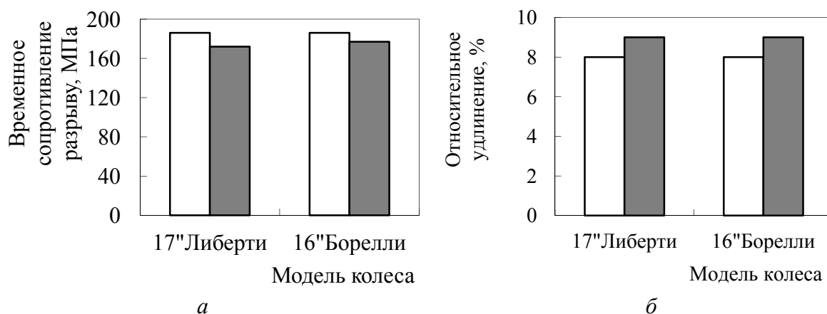
Рисунок 24 – Временное сопротивление разрыву (а) и относительное удлинение (б) автомобильных колес моделей 17Либерти и 16Борелли, отлитых из сплава АК12: □ – модифицирование лигатурой AlTi5B1; ■ – с применением гранулированного флюса
