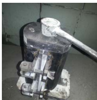
Рисунок 2 – Кокиль для изготовления технологических проб (а), образцы проб до (б) и после (в) рафинирования
