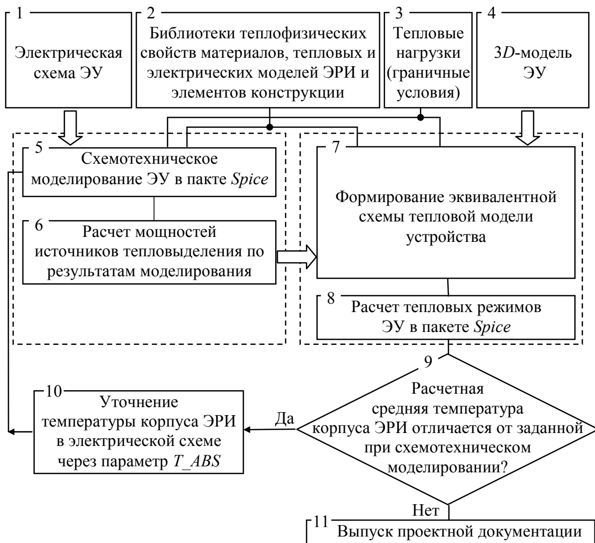
Рисунок 1 – Процедура анализа проектных решений по результатам связанного электрического и теплового моделирования ЭУ КА
