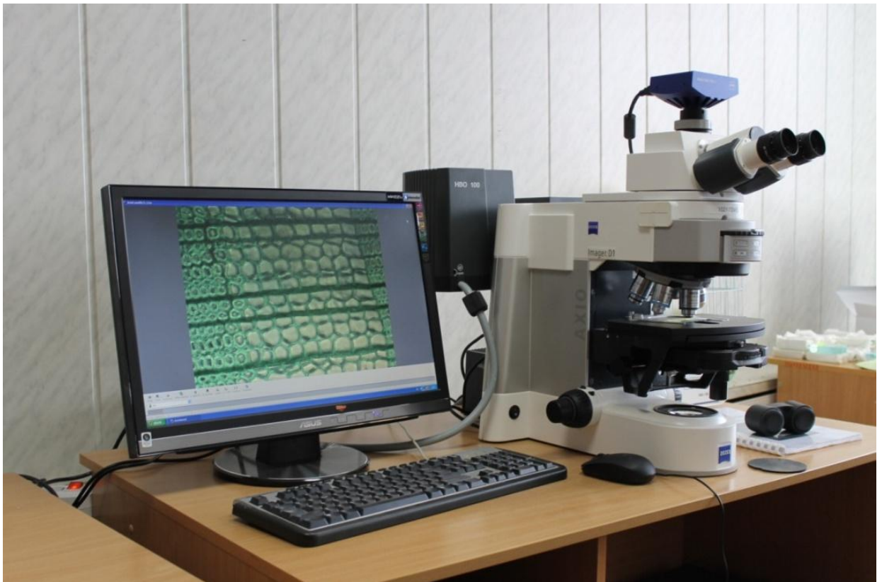
Рисунок 2.5. Система анализа изображений: биологический микроскоп с установленной цифровой камерой, персональный компьютер
